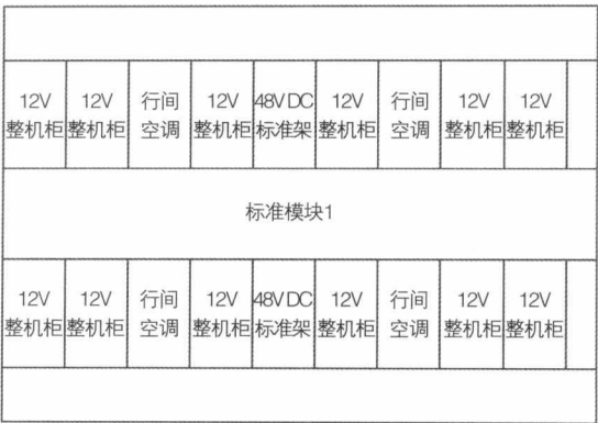
图6 标准化供电系统集装箱（微模块）应用场景
