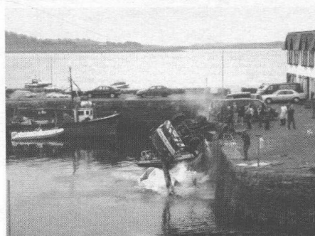
(c) 吊车倾翻后与落水轿车一起落水
