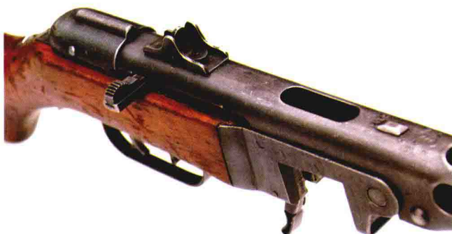
50 式冲锋枪为开膛待击，射击前枪机处于后方位，便于散热，但不利于提高射击精度
