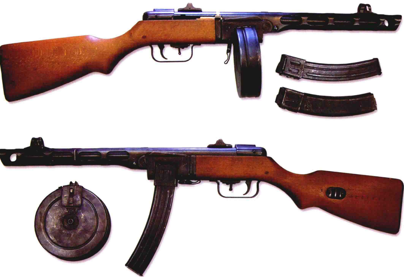
战场上波波沙冲锋枪一般配置一个 71 发弹鼓以及几个 35 发弹匣备用
