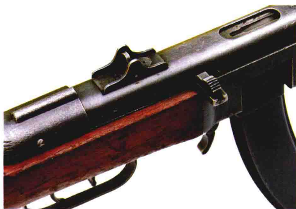
50 式冲锋枪采用波波莎冲锋枪前期的翻转式觇孔照门设计，简单易用
