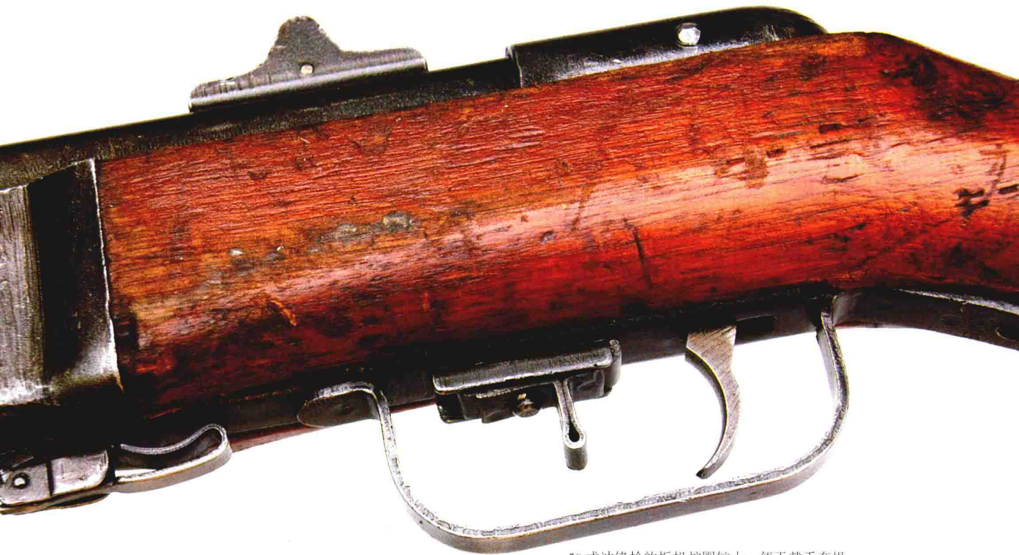
50 式冲锋枪的扳机护圈较大，便于戴手套操作。扳机前方为快慢机，此时为单发状态
