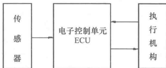
图 1-3 电子控制系统组成
