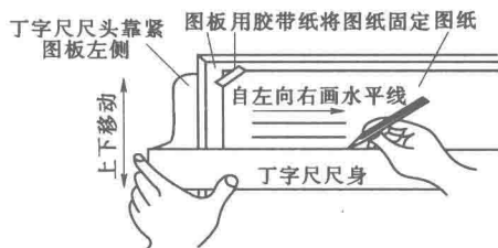
图 2-1-2 用丁字尺画水平线
