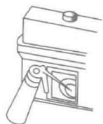
图1-1 向气缸内注入机油
