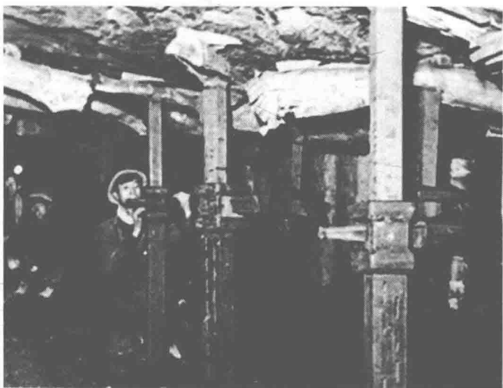
图 1-5 摩擦式金属支柱工作面
