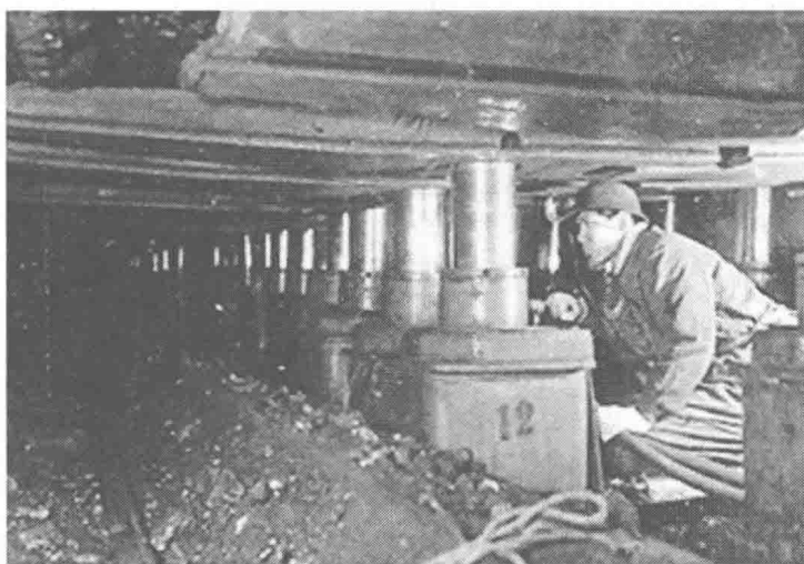
图 1-6 TZ-1 型液压支架工作面
