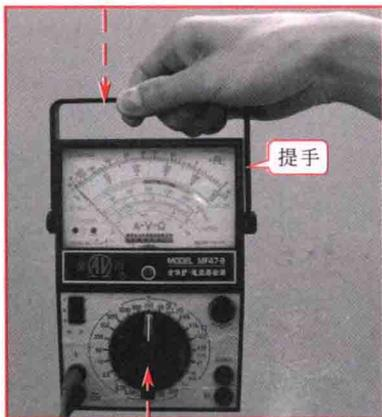
功能旋钮可以进行360°旋转，根据被测量的不同和项目的不同旋转至相应的挡位
