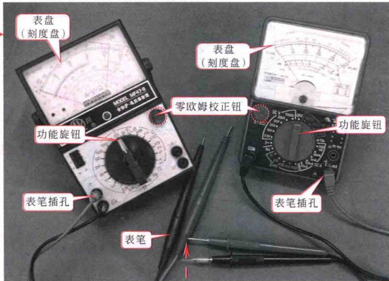
指针万用表附带有两支表笔（红色和黑色），使用时，将两表笔分别插在指针式万用表的表笔插孔上，即可通过表笔对被测器件或电路进行检测
