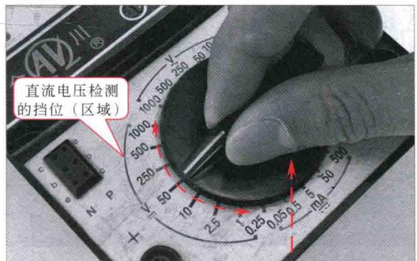
直流电压检测的挡位(区域)
