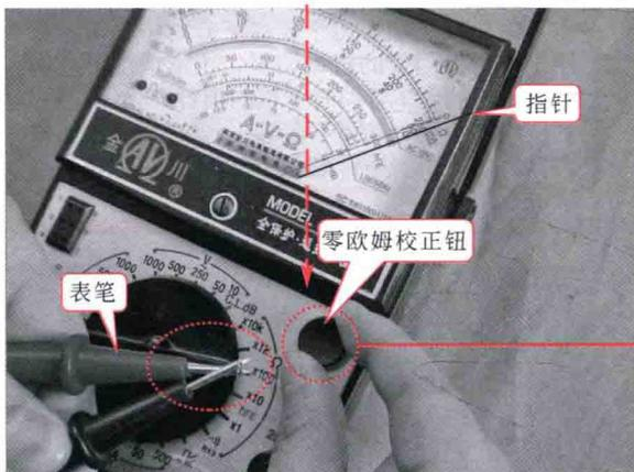
通常，指针万用表测量电阻时需要万用表自身的电池供电，且在万用表的使用过程中，电池会不断地损耗，会导致万用表测量电阻时的精确度下降，所以测量电阻值前都要先通过零欧姆校正钮进行调零，或称 $0\Omega$ 调整
