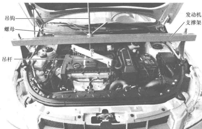
图 1-12 安装发动机吊装工具
