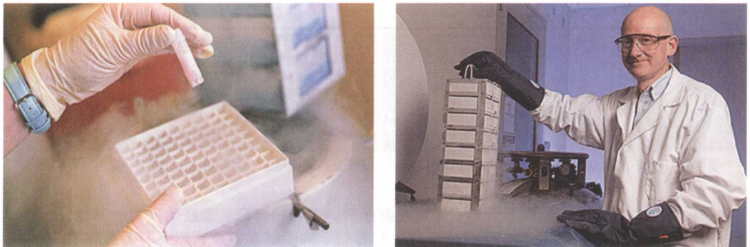
图1-6 细胞或早期胚胎均可以超低温长期储存。通常是将细胞或胚胎放入冷冻培养液，分装到冷冻小管中，做好标记，放入液氮（ -196^{\circ}\text{C} ）中长期储存，需要时可以取出解冻，将胚胎植入母体发育或者继续进行细胞培养。如果冻存条件适当，细胞和胚胎都可以存活数十年以上。
