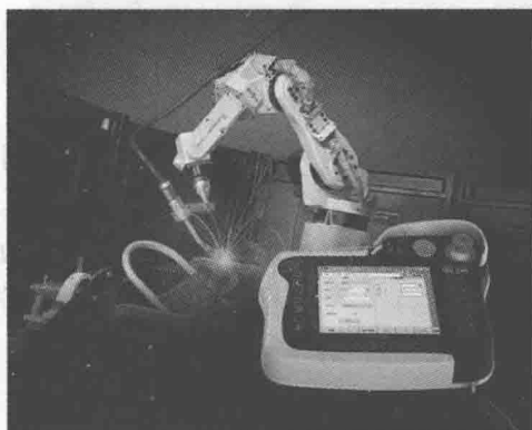
a) 焊接机器人
