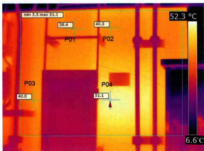
图 2-11 变压器本体一侧发热红外图
