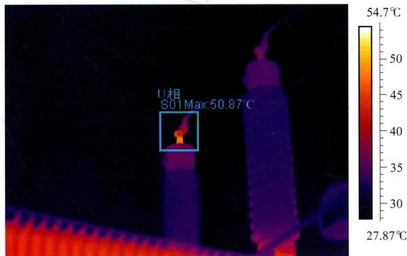
图 2-12 相间温升在 15°C 以上，接头接触不良
