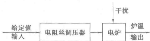
图 1.2 电加热炉开环控制原理图
