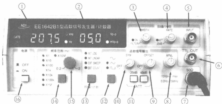
图 1.3 EE1642B1 型函数信号发生器面板图
