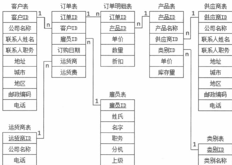
图 1-1 newNorthwind.accdb 数据库各表间的联系
