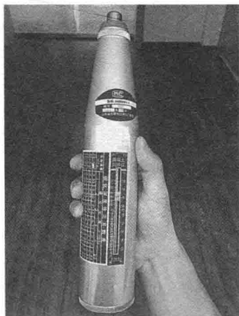
图 2.1 混凝土回弹仪
