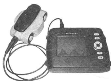
图 2.5 混凝土厚度钢筋测试仪
