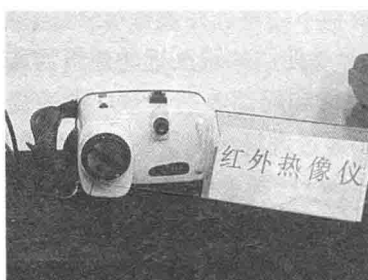
图 2.6 红外热成像仪
