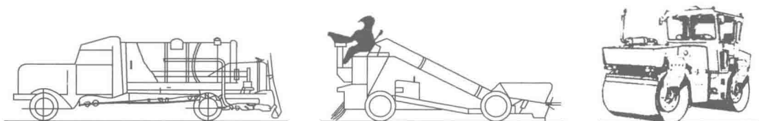
图 1-4 贯入沥青路面施工工艺过程图
