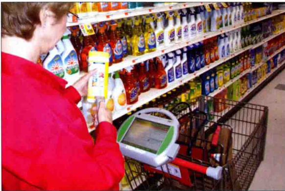
由 Cuesol 公司开发的购物伴侣是一种安装在购物车上的无线电脑设备。利用这个设备扫描商品,顾客可以知道自己的消费情况。（见正文第 319 页）
