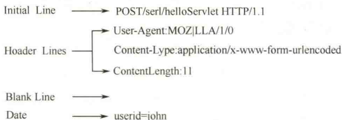
图 1.3 提交表单产生的 POST 请求消息
