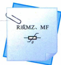
热敏电阻器的电路图形符号
