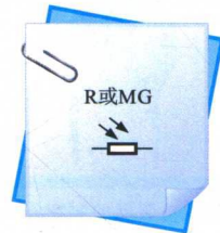
光敏电阻器的电路图形符号
