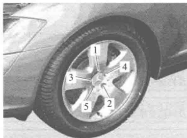
图 1-1-11 车轮螺栓紧固顺序 (1 → 2 → 3 → 4 → 5)
