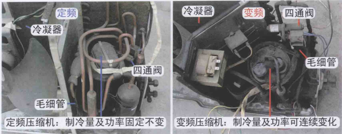
图1-9 室外机制冷系统主要部件
