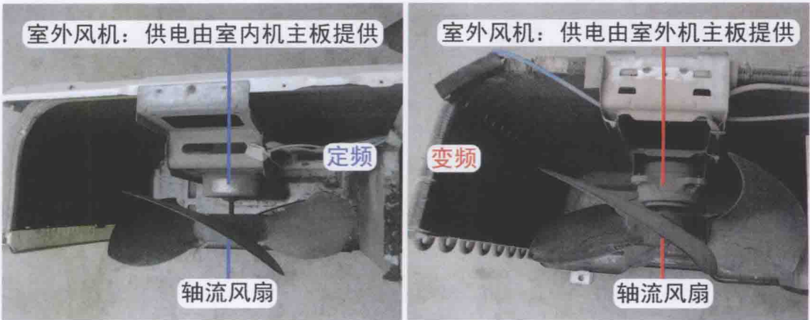
图1-10 室外机通风系统
