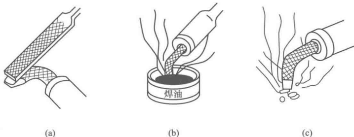
图 1-18 电烙铁端头上锡过程
