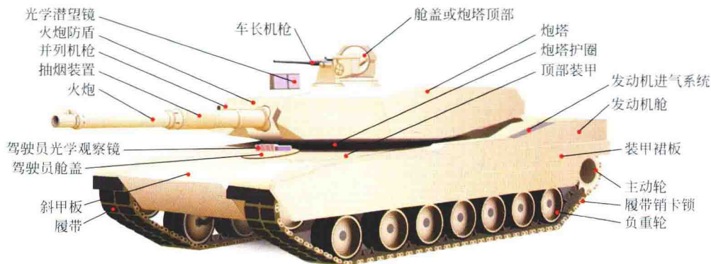
图 1-4 坦克的一般构造
