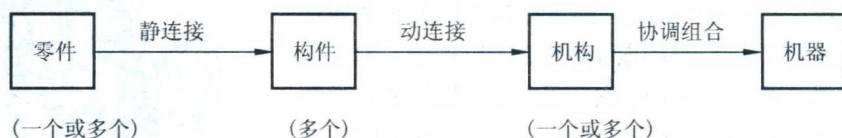
图 1-3 机器按结构的组成关系
