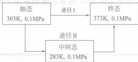
图 1-1 氮气的状态变化
