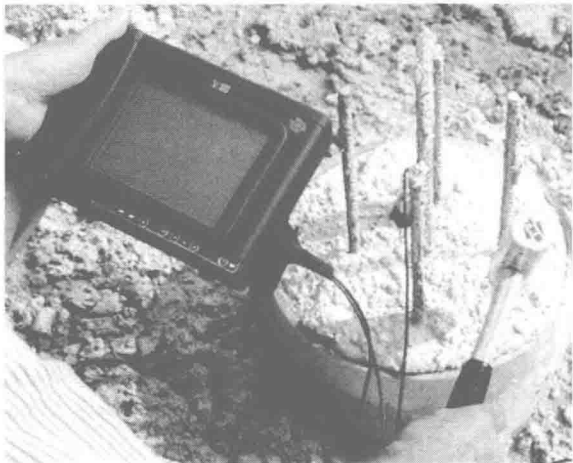
图 1-8 桩基完整性低应变反射波动力检测
