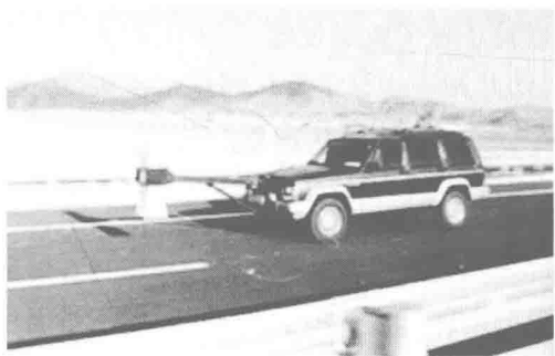
图 1-11 高速公路探地雷达测试
