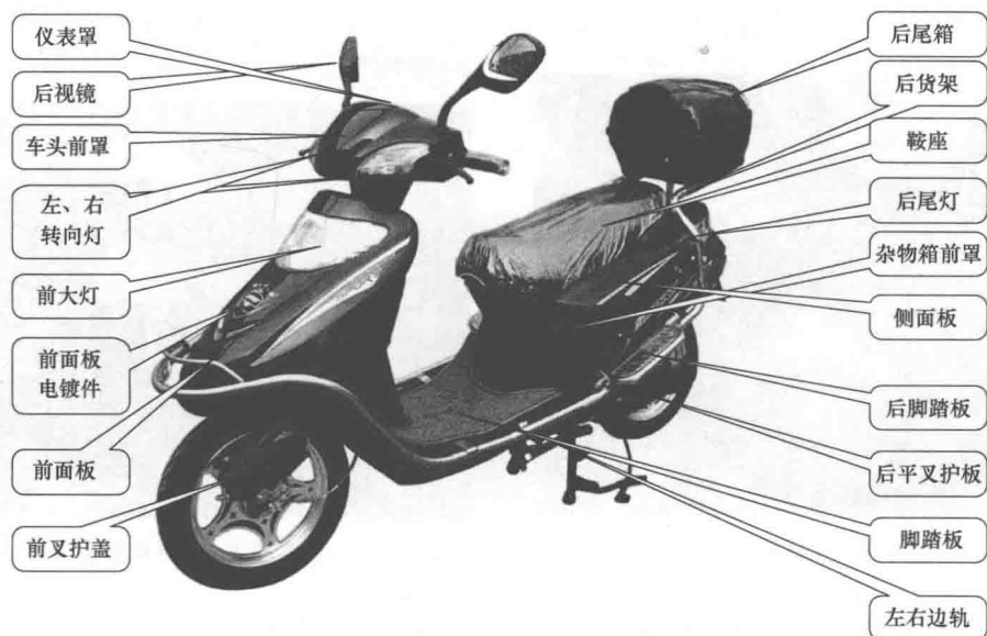
图 1-5 豪华型电动自行车组成部件
