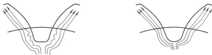
(a) 齿根圆角形状对型腔内塑胶熔体流动的影响
