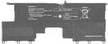
索尼Pro 11的聚合物锂电池,这种电池不仅很薄,且可根据机身内部构造定制成异形
