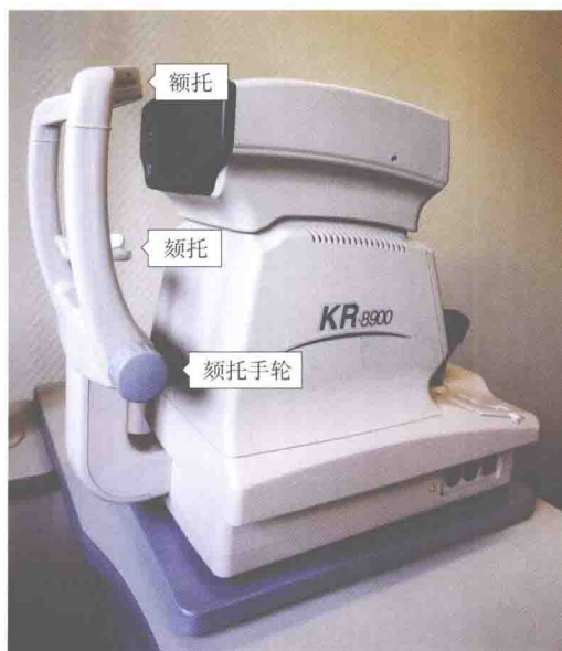
图 1-4 电脑验光仪的支架部件
