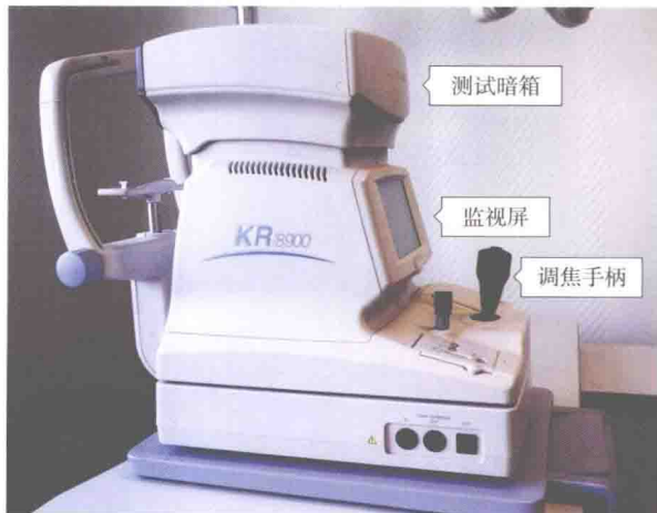
图 1-1 电脑验光仪的测试部件
