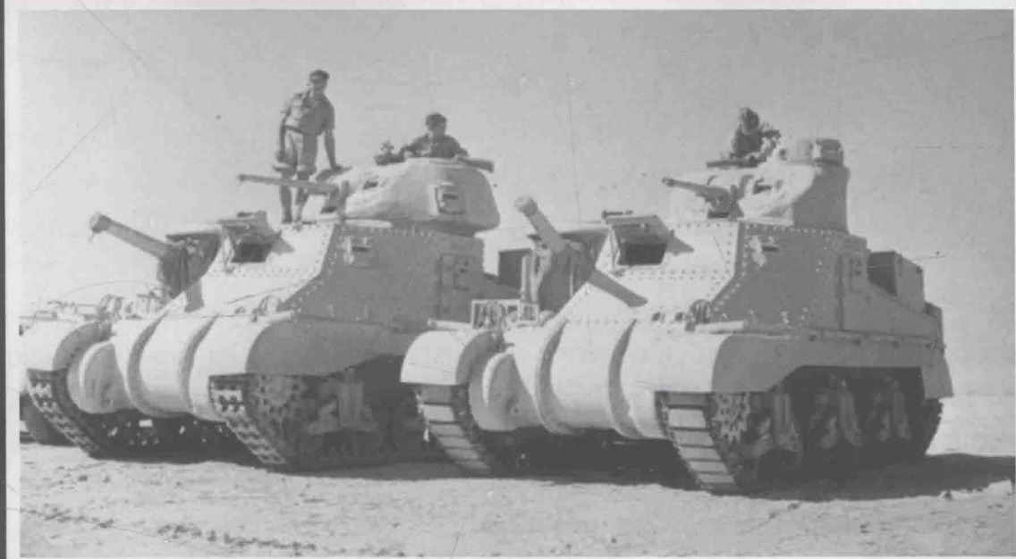
■ 上图是1942年7月7日在埃及的阿拉曼，英军第1装甲师第2装甲旅第4女王直属轻骑兵团C中队的M3“格兰特”中型坦克（左）与M3“李”中型坦克。这两种坦克的武备实际上是一样的，同样为一门37毫米M5型坦克炮和一门75毫米M2型坦克炮，只是小炮塔的外形不同，它们使英军首次获得了对德军坦克和反坦克炮的火力优势。
