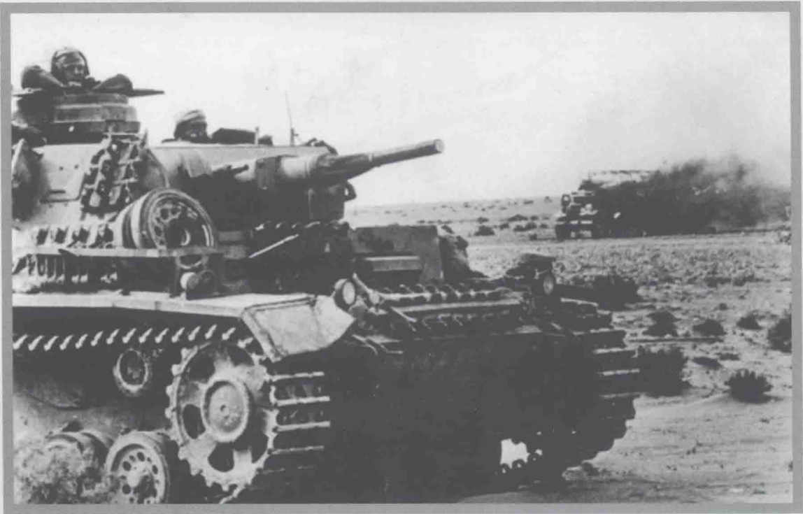
■ 1942年2月18日在北非利比亚，一辆德军三号 H 型坦克从一辆燃烧的英军卡车旁驶过。三号 H 型坦克的炮塔和车体正面装有表面硬化装甲制成的32 毫米附加装甲，能够有效抵御英军2 磅坦克炮和反坦克炮发射的实芯穿甲弹。
