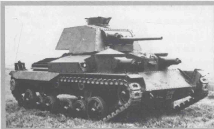
■ 英国 MK 1 型巡洋坦克，装备 1 门 2 磅坦克炮和 3 挺维克斯机枪，总重 12 吨，装甲厚度 6~14 毫米，车组成员 6 人，最大时速 40 公里，只制造了 125 辆。
