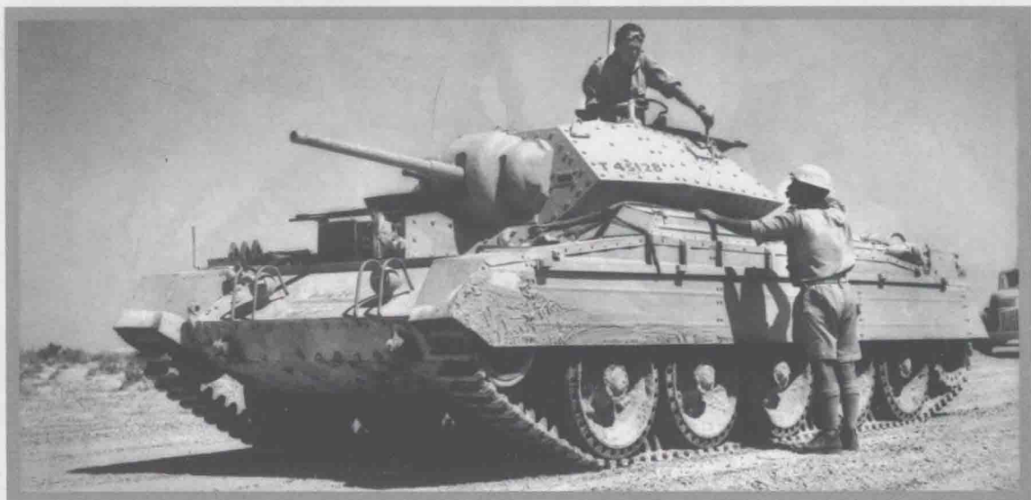
■ “十字军”1型和2型装备的都是2磅坦克炮，到了3型才装备6磅坦克炮。上图是1942年10月在北非战场拍摄的一辆“十字军”1型巡洋坦克，下图是1943年1月在北非战场拍摄的一辆“十字军”3型巡洋坦克，注意它们坦克炮的区别。
