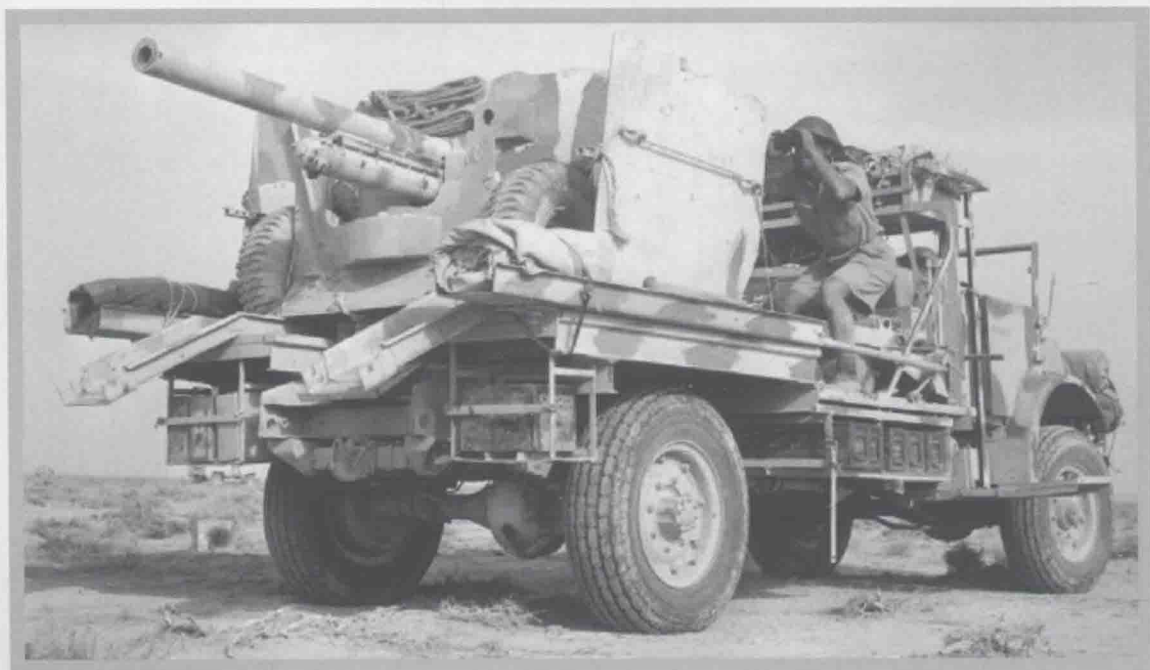
■ 上图 为 1942 年 5 月 31 日 加 扎 拉 战 役 期 间 拍 摄 ， 英 军 的 一 门 6 磅 反 坦 克 炮 被 装 在 卡 车 上 用 作 机 动 火 炮 。
