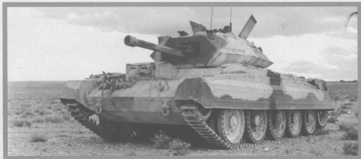
■ “十字军”1型和2型装备的都是2磅坦克炮，到了3型才装备6磅坦克炮。上图是1942年10月在北非战场拍摄的一辆“十字军”1型巡洋坦克，下图是1943年1月在北非战场拍摄的一辆“十字军”3型巡洋坦克，注意它们坦克炮的区别。
