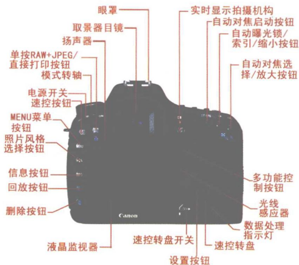
图1-2 相机的背面结构
