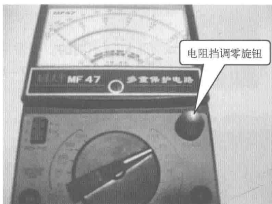
(a) 电阻挡调零旋钮
