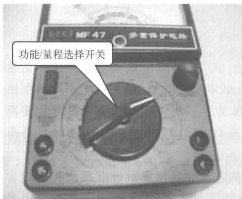
图 1-7 MF-47 型万用表的功能/量程选择开关
