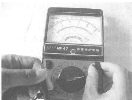
图 1-13 MF-47 型万用表的电阻挡调零
