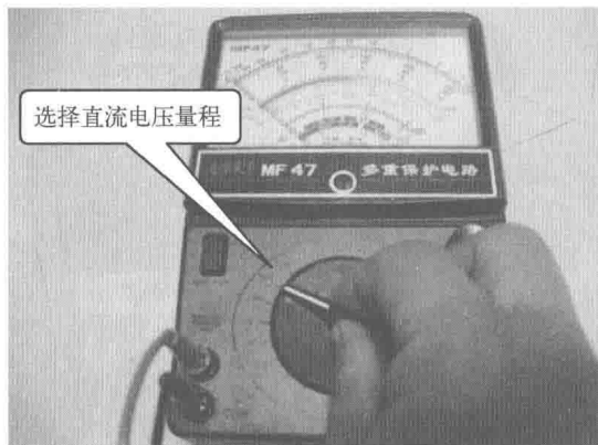
(a) 选择合适的直流电压量程
