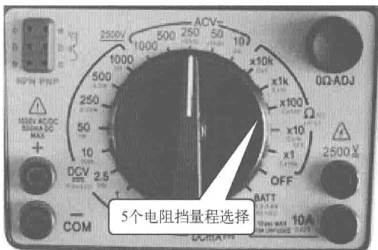
图 1-11 MF-47 型万用表的电阻挡量程
