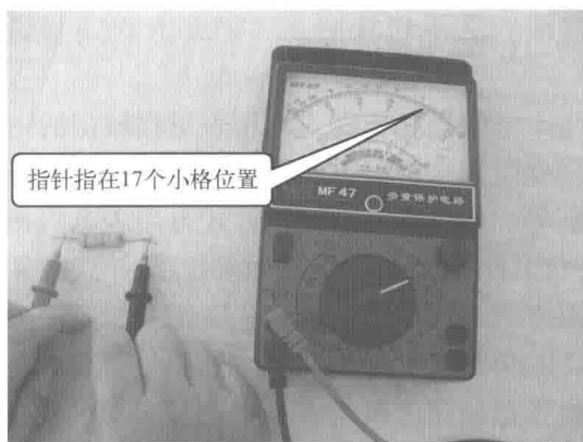
图 1-14 用 MF-47 型万用表电阻挡测量电阻器的读数
