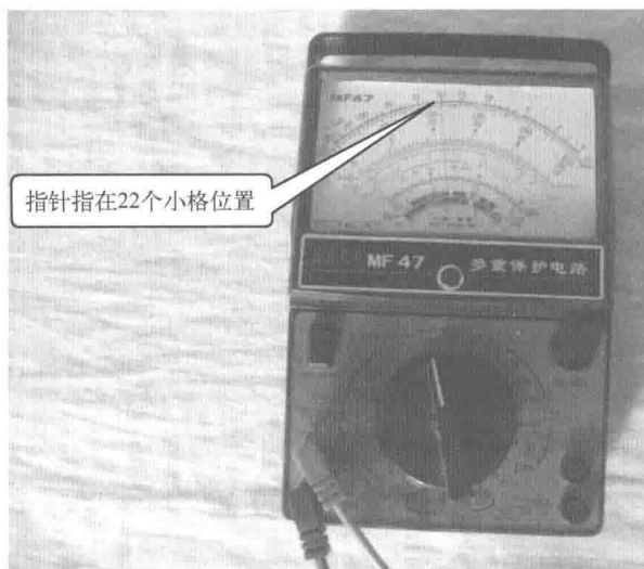
图 1-20 用 MF-47 型万用表电压挡测量电压的读数
