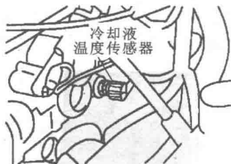
图 1-16 冷却液温度传感器安装位置
