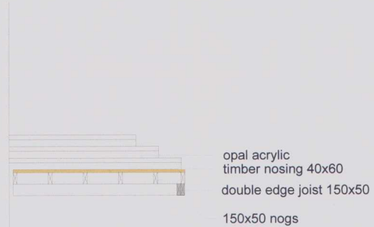
SECTION DD – TYPICAL STEP DETAIL DD 截面 - 标准台阶细节图
