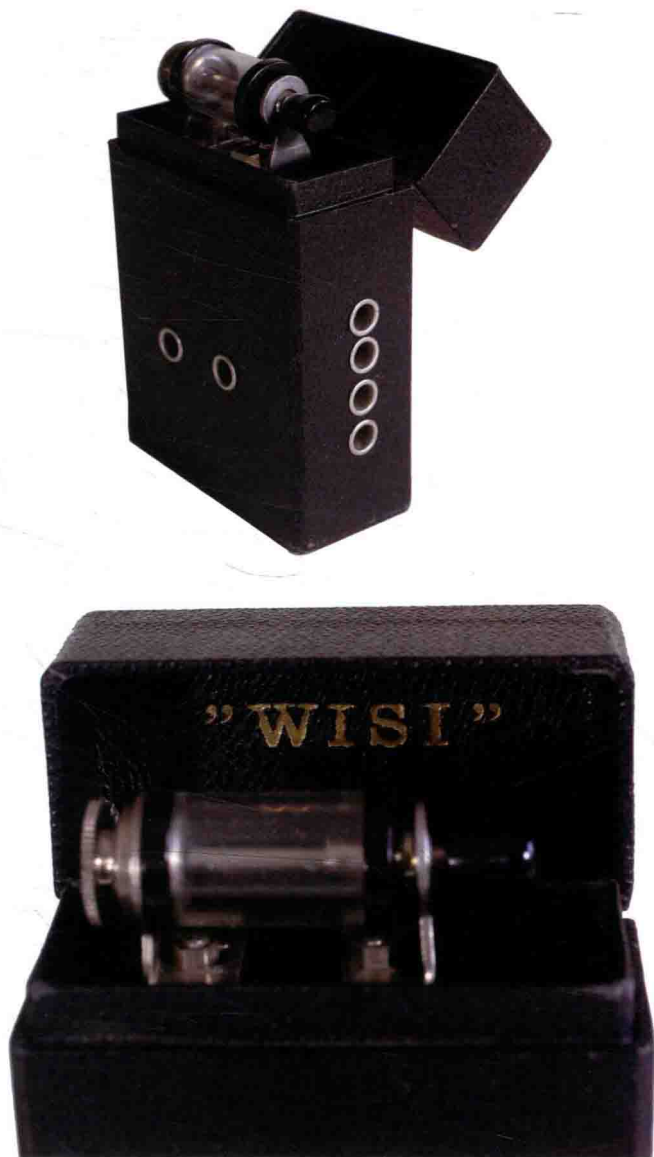
图1-5 德国1933年出品的WISI.NR.56型矿石收音机
