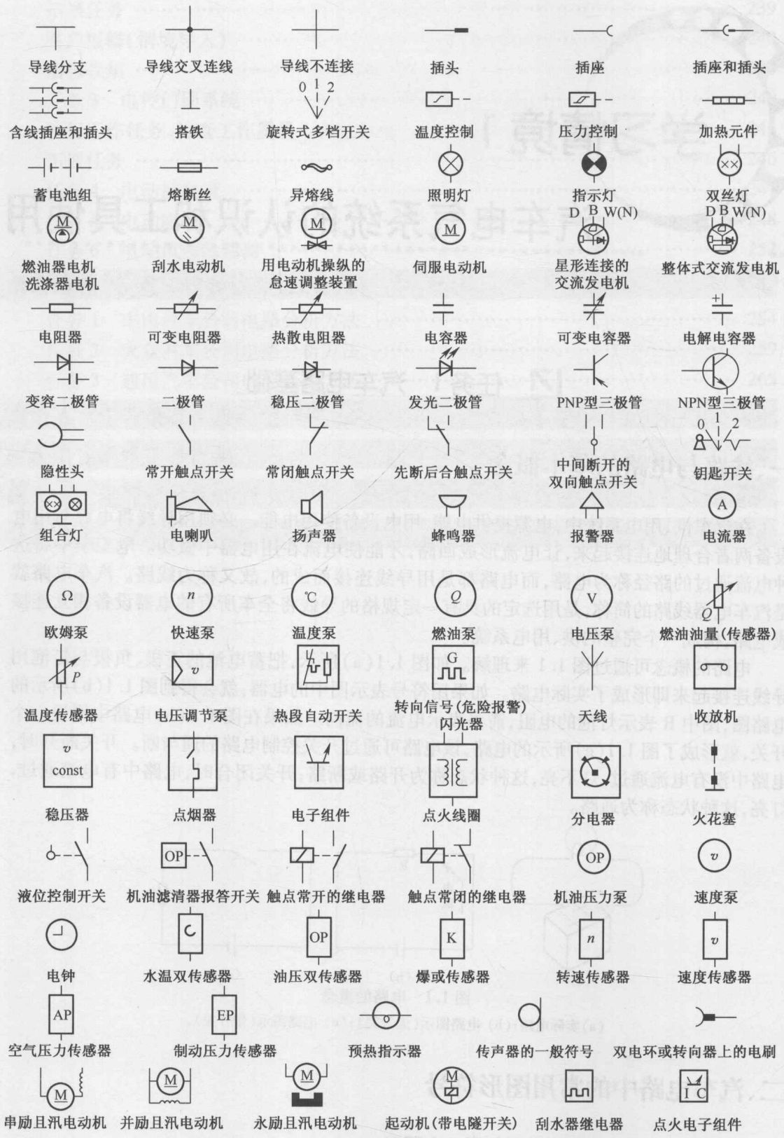
图 1.2 汽车电路中的常用图形符号
