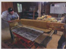
红陶板表面加工工序（手工制作）
