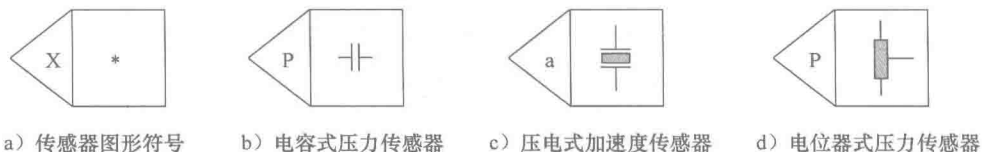
图 1-8 典型传感器图用图形符号
