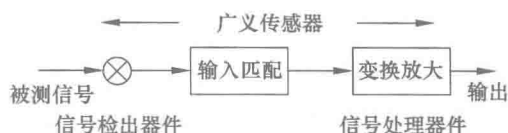
图 1-5 广义传感器原理结构框图
