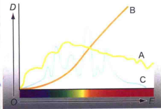
图 7-26 不同光源的波长分布 A—太阳光;B—白炽灯;C—荧光灯; D—分布;E—波长
