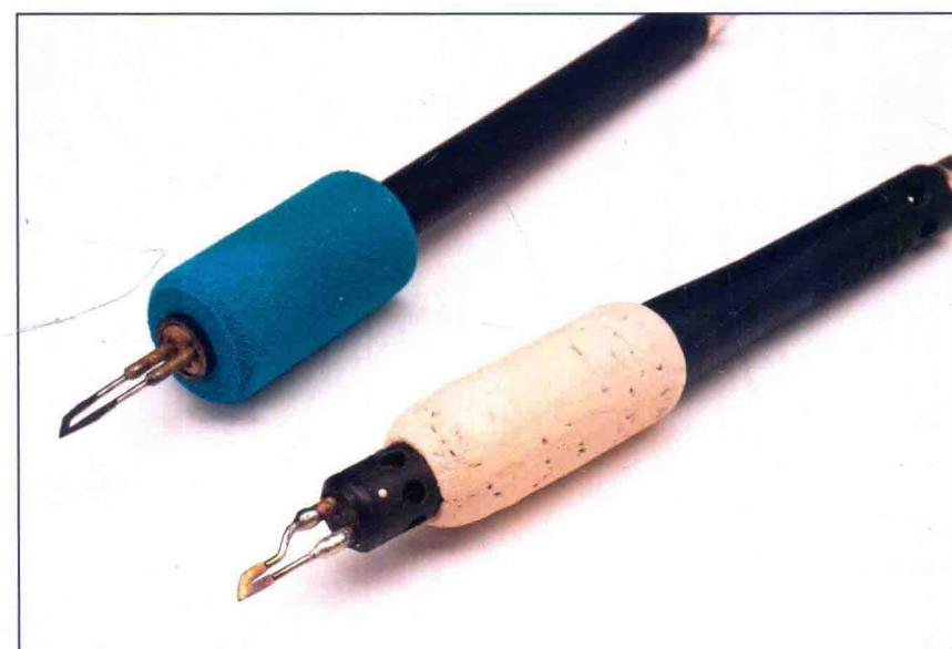
**烙笔手柄** 图片上方的烙笔手柄包有一层厚厚的蓝色泡沫，将使用者的手指与烙笔散发的热量隔绝。图片下方的烙笔前端距笔头有一小段距离并且设有通风孔，促使使用者的手指挪回到通风孔上方，与烙笔最热的部分隔绝开来。
