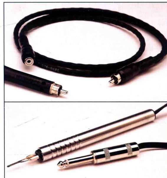
**电机接线** 大多数木烙工具都是通过RCA插头（顶部图片所示）连接烙笔与电机的。有些装置（底部图片所示）通过直径为6.35毫米的耳机插头完成此连接。
