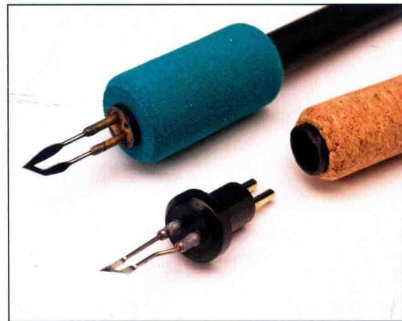
**烙笔种类** 可更换笔头（上图所示分开的零件）的烙笔可使你不必花多少钱就能增加库存，获得笔头形状不同的烙笔。笔头固定的烙笔（上图所示蓝色手柄）能够减小可换笔头与整个装置连接处的任何热量流失或能量损耗。
