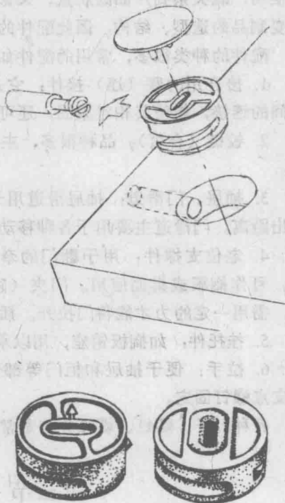
图 1-1 偏心联接件的接合
