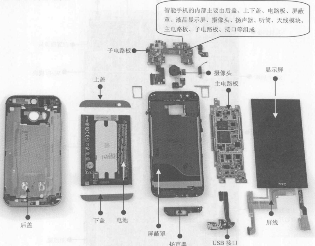
图 1-2 智能手机的内部结构
