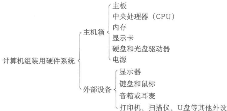
图 0-2 计算机组装用硬件系统示意图
