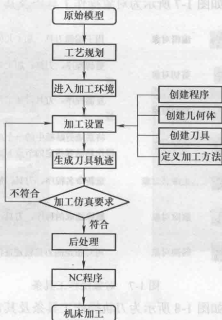
图 1-9 UG NX8.0 数控加工一般流程
