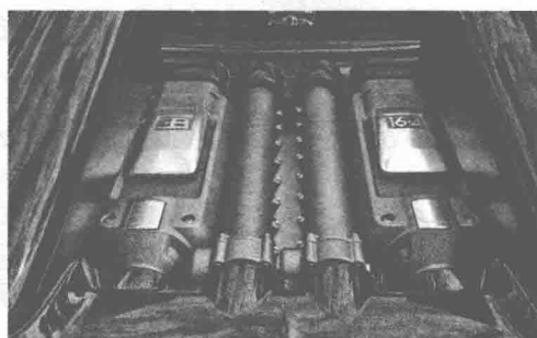
图 1-1-17 布加迪威龙十六缸发动机
