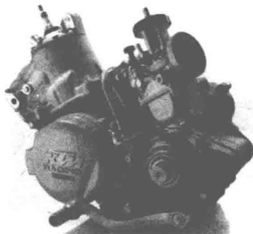
图 1-1-9 二冲程发动机
