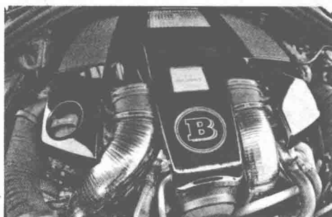
图 1-1-16 巴博斯改装十二缸发动机
