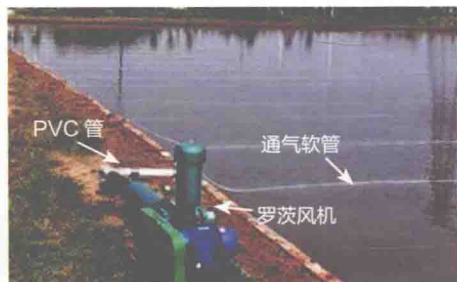
彩图 2-9 微孔曝气增氧装置
