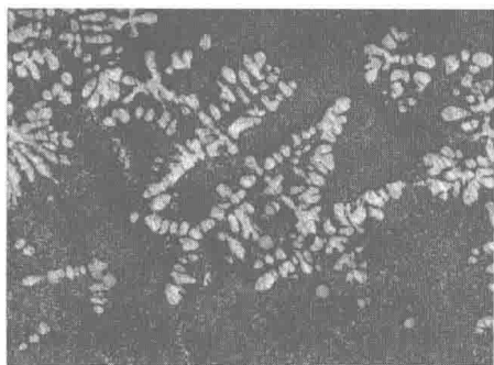
图 1-7 铸造铝合金 (ZL104) 显微组织 (×100)
