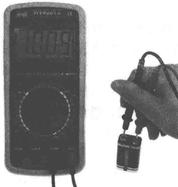
图 1-9 万用表测量直流电压
